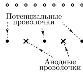
Рис. 8.28. Принципиальная конструкция плоской дрейфовой камеры
